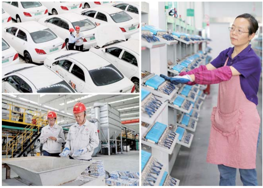
左上图：安徽绿沃循环环保科技有限公司，工作人员联合车辆管理部门对回收废旧新能源汽车进行逐辆登记注册。左下图：工人对拆除的电机进行破碎脱粉等工艺处理。右图：分容车间，工人对已包膜的电池进行充电。
