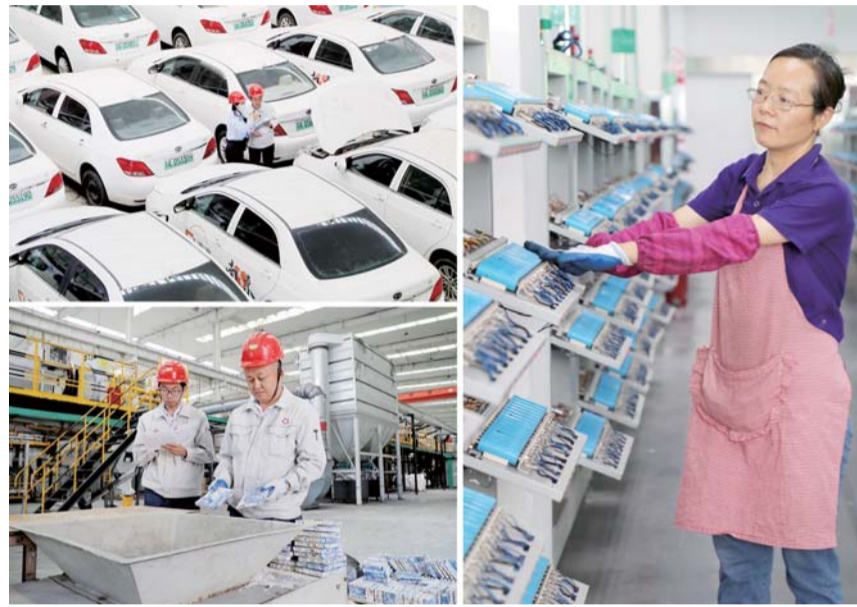
左上图:安徽绿沃循环能源科技有限公司,工作人员联合车辆管理部门对回收进厂报废新能源汽车进行逐辆登记注册。左下图:工人对拆除的电池进行破碎脱粉等工艺处理。右图:分容车间,工人对已包膜的电池进行充电。
